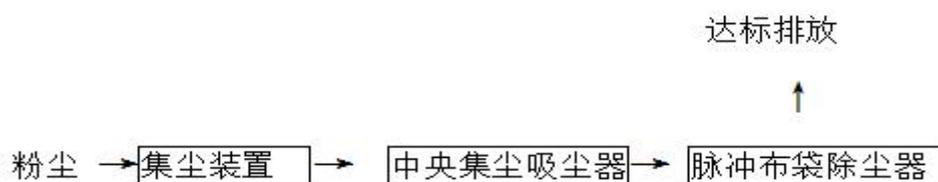
图 4.1-6 木材加工粉尘处理工艺流程图
