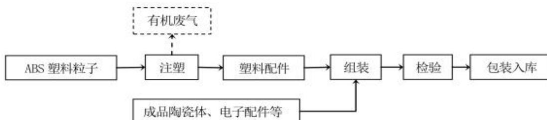
3.5-5 智能马桶生产工艺流程图
