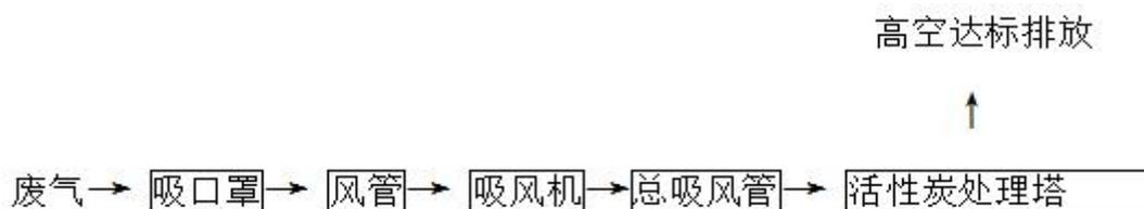
图 4.1-7 注塑废气及亚克力板预热废气处理工艺流程图
