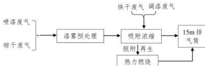
图 4.1-6 环评建议调漆、喷漆、烘干废气处理工艺流程图
