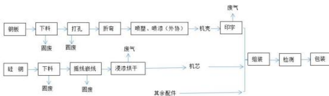
图 2-4 环评交流电焊机生产工艺流程图
