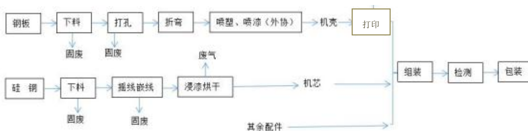
图 2-5 实际交流电焊机生产工艺流程图
