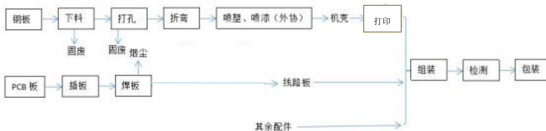
图 2-3 实际逆变电焊机生产工艺流程图
