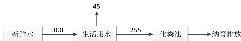
图 2-1 项目水平衡图 (单位: t/a)
