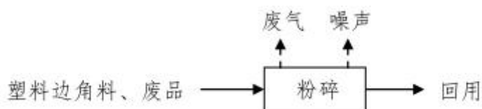
图 3.4-6 塑料边角料和废品粉碎回用工艺流程
