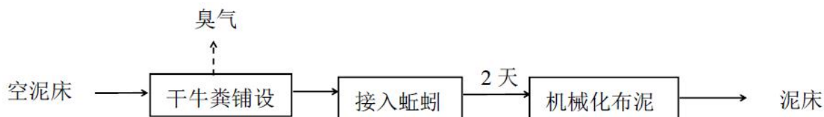
图 2-3 本项目实际生产工艺流程及产污环节图
