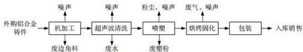
图 4.1-3 30 万套泵壳的生产工艺流程及排污节点图
